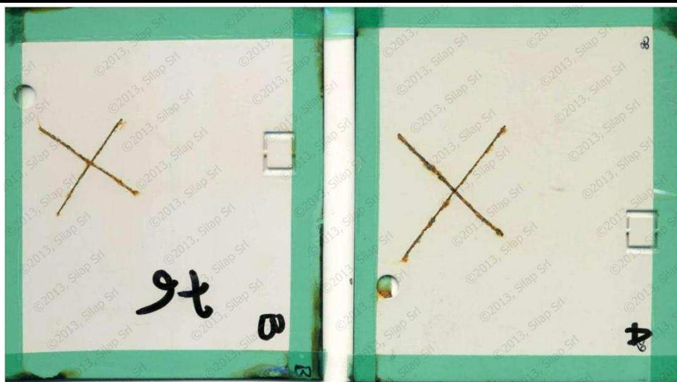
**Figura 9** – risultati umidostato dopo 627 ore; a sinistra campione B, a destra campione A
